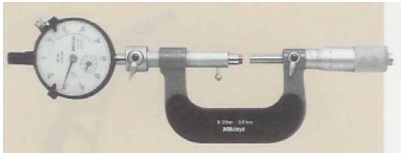
그림 2.38 다이얼 게이지 부착 마이크로미터
