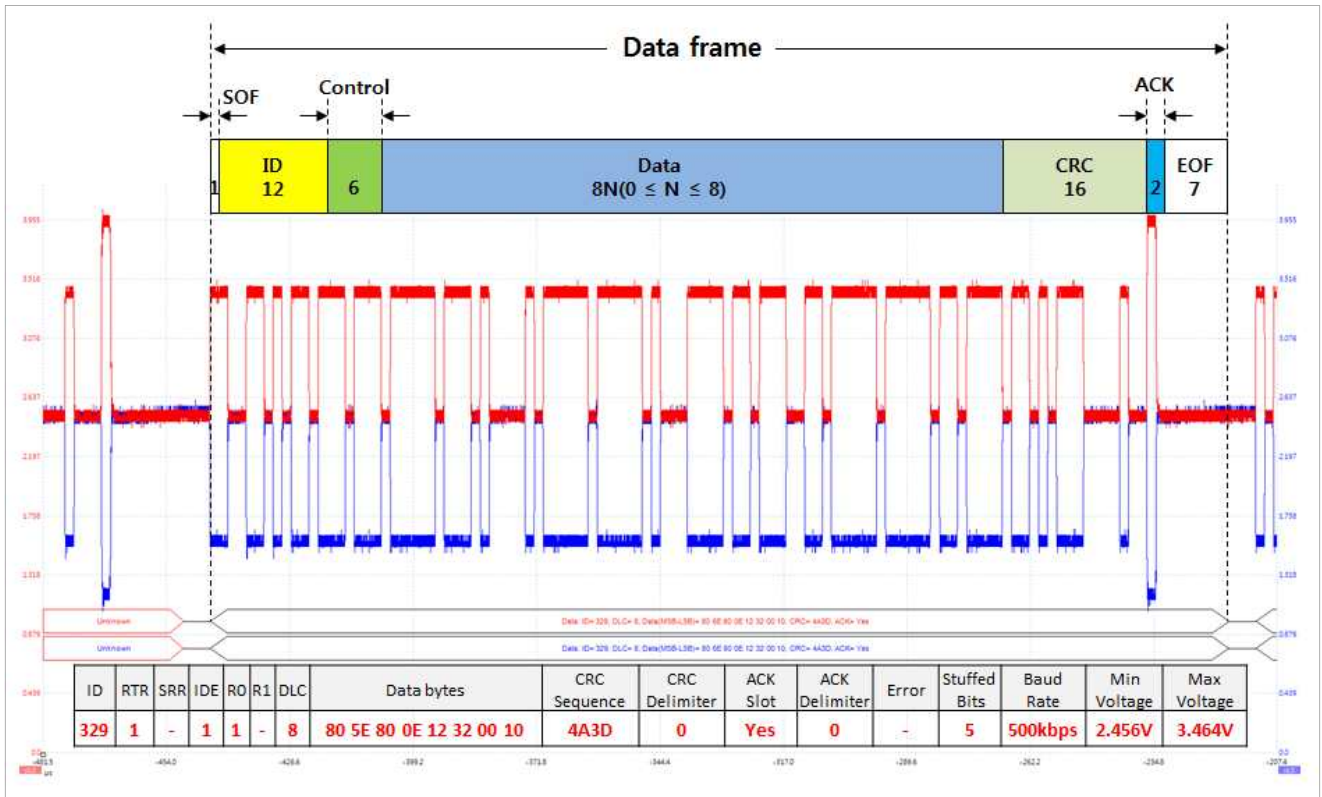
그림 1) CAN 2.0A의 데이터 프레임
